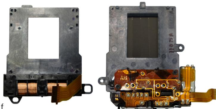
*Während der neue elektromagnetisch gesteuerte Verschluss der Panasonic Lumix DMG-GX80 (links) sehr leise und vibrationsarm arbeitet, kommt beim Verschluss der GX7 noch die alte Mechanik mit starken Spannfedern und elektrischer Steuerung zum Einsatz. [Foto: MediaNord]*
